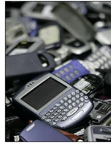
ภาพโทรศัพท์รุ่นใหม่และเก่าที่มีส่วนประกอบของสารหรือชิ้นส่วนอิเล็กทรอนิกส์ที่เป็นพิษ เช่น (1. & 2.) Cover and key pad - chromium, PVC, brominated flame retardants (3.) LCD screen - liquid crystals (4.) Circuit board - lead, brominated flame retardants (PBB, PBDE), mercury (5.) Battery - cadmium, nickel, lithium ที่มา: news.bbc.co.uk/2/hi/science/nature/6174422.stm
