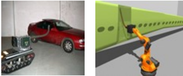
ภาพแสดง: บางตัวอย่างการนำหุ่นยนต์แขนงไปใช้งาน ที่มา: www.ocrobotics.com/casestudies/index.html
