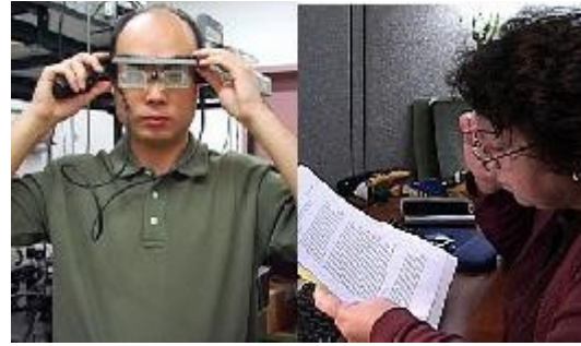
ภาพ : เลนส์อิเล็กทรอนิกส์ชนิดใหม่ที่สามารถสลับโฟกัสระหว่างไกลและใกล้ได้ โดยแต่ละสวิตช์ขนาดเล็กเบาๆ ที่มา : http://www.sciencentral.com/articles/view.php3?article_id=218392793&cat=3_3
