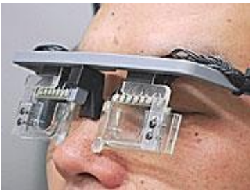
ภาพ : แว่นตาดันแบบเลนส์อิเล็กทรอนิกส์ ที่มา : http://www.sciencentral.com/articles/view.php3?article_id=218392793&cat=3_3
