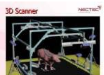
แบบจำลองเครื่องสแกนแบบ 3 มิติสำหรับควาย ซึ่งเป็นการพัฒนาต่อยอดมาจากเครื่องสแกนร่างกายคนแบบ 3 มิติเช่นกัน แต่ปรับให้ใช้เวลาในการสแกนสั้นลง เพราะสัตว์ไม่สามารถนิ่งได้นานเท่าคน
