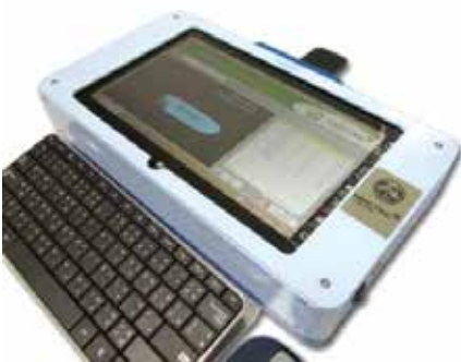
A-Rice: เครื่องวัดขนาดคัพภะของเมล็ดข้าว (Rice Embryo Analyzer)
